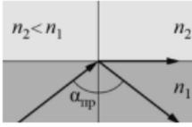
Полное внутреннее отражение.<br>Предельный угол полного внутреннего отражения: $\sin \alpha_{\text{пр}} = \frac{1}{n_{\text{отн}}} = \frac{n_2}{n_1}$                                                                                                                                                                                                                                                                                                          |
